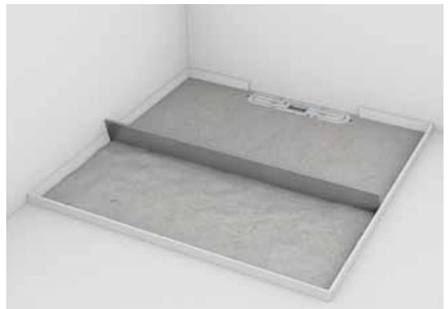
**Step 3:** Il massetto è posato con una pendenza dall'1 al 2% rispetto al muro. La protezione trasparente del pozzetto, montata in fabbrica, lo protegge da danni e sporco durante la posa.
