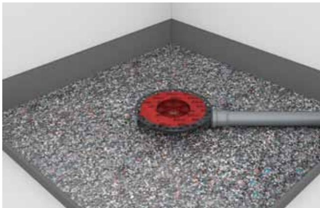
**Step 1:** Prima di montare e collegare il pozzetto, la base viene preparata adeguatamente mediante misure di isolamento acustico.
