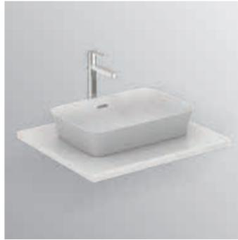
Lavabo ultrasottile rettangolare 550 mm da appoggio su piano con foro del troppopieno e senza foro per la rubinetteria. Il lavabo è realizzato in Diamatec®, rivoluzionario materiale ceramico estremamente robusto che permette di unire bordi lineari super sottili (solo 3,8 mm) ad una durabilità estrema. Dima e fissaggi inclusi nella confezione.
